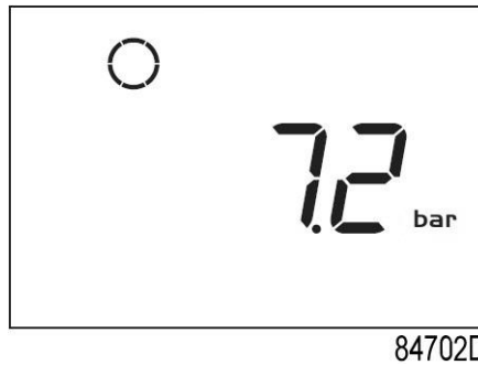
Основной экран с показателем давления (остановленный компрессор)
