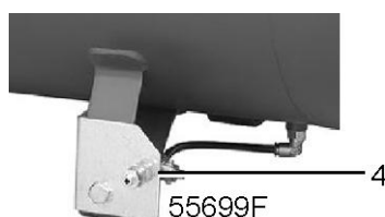
Клапан слива воздушного ресивера
