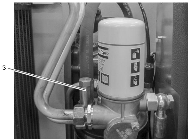
Заглушка маслоналивного отверстия
