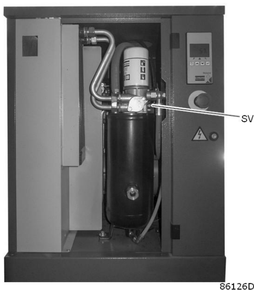
Предохранительный клапан на компрессоре
