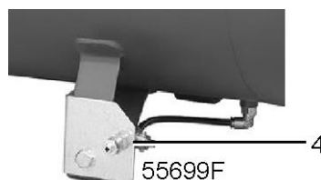
Клапан дренажа конденсата на воздушном ресивере
