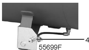
Клапан дренажа конденсата на воздушном ресивере
